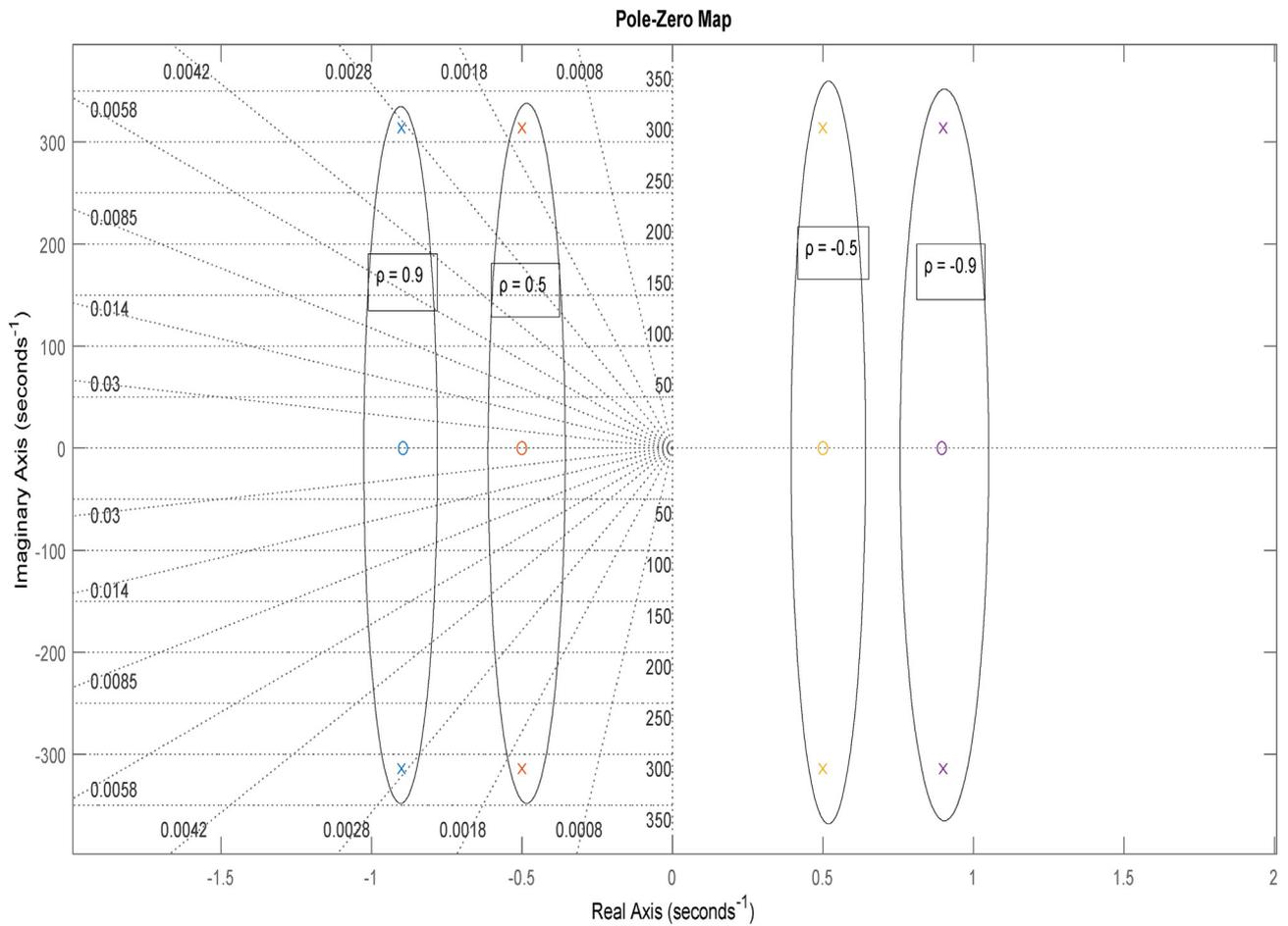
Fig. 11a. Pole zero plot of U-SOGI.
