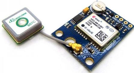
Fig. 14. Neo 6M GPS Module
