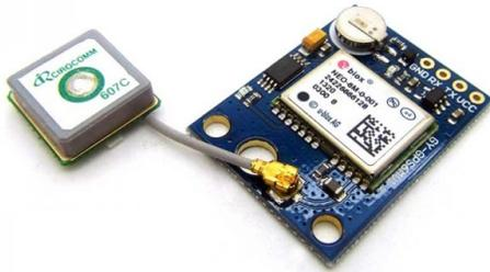
Fig. 14. Neo 6M GPS Module
