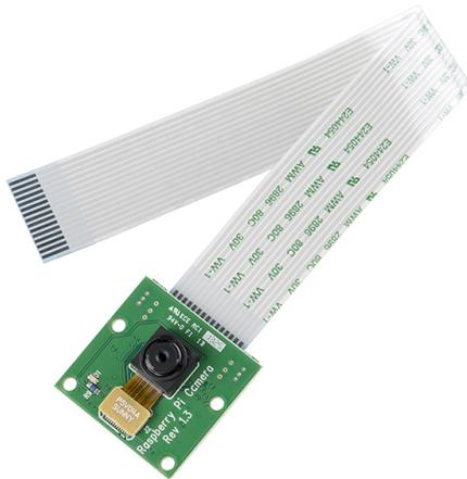
Fig. 15. Raspberry pi camera module
