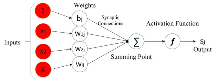
Fig. 2. The diagram of a neuron.
