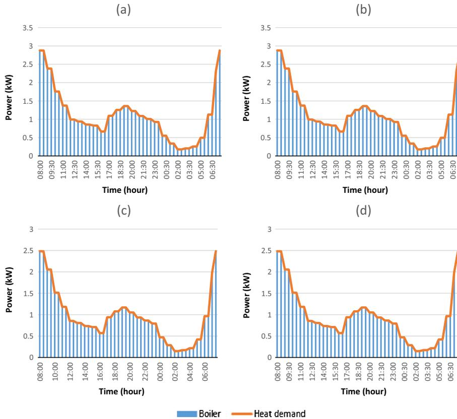
Fig. 7. "Macro" mode thermal balance, scenarios: (a) WME (b) WMO (C) SME (d) SMO.
