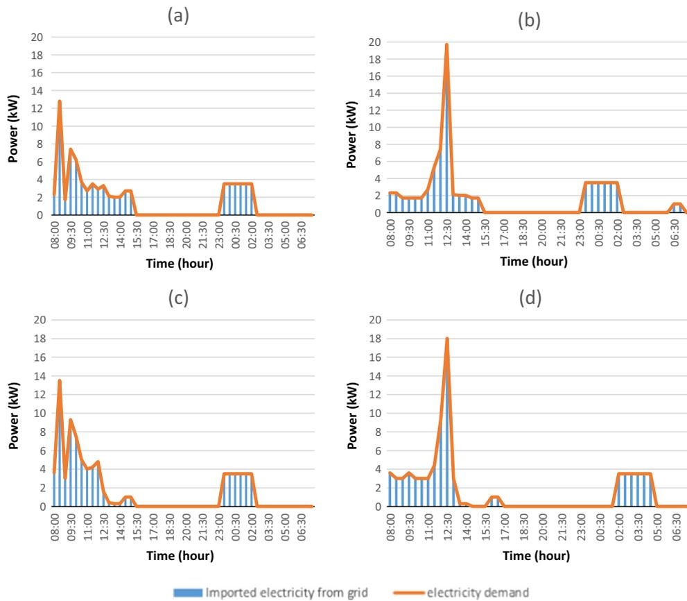
Fig. 5. “Macro” mode electrical balance, scenarios: (a) WME (b) WMO (C) SME (d) SMO.
